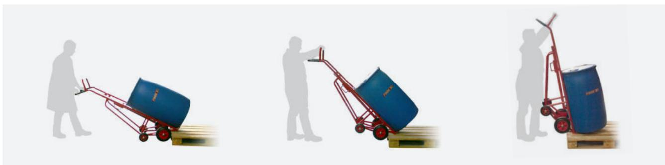
Pose et dépose d'un fût sur palette
